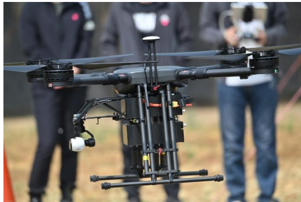
DJI 如風 4 (11+10Kg 載重, 105cm 軸距)
